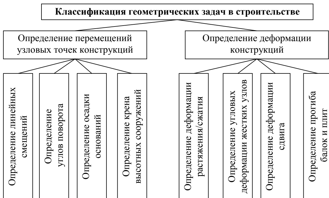
а) Классификация основных геометрических задач в строительстве
