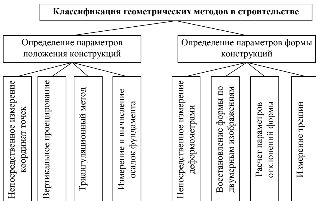
б) Классификация основных геометрических методов в строительстве
