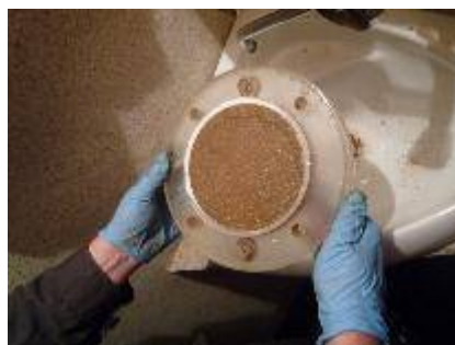
Рисунок 3 - Фильтр со слоем взвешенного вещества
