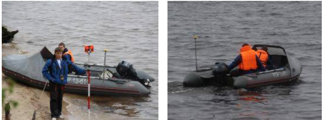
Рис. 2. Съёмка подводной части берега гидрометрическим промерным комплексом на базе маломерного судна
