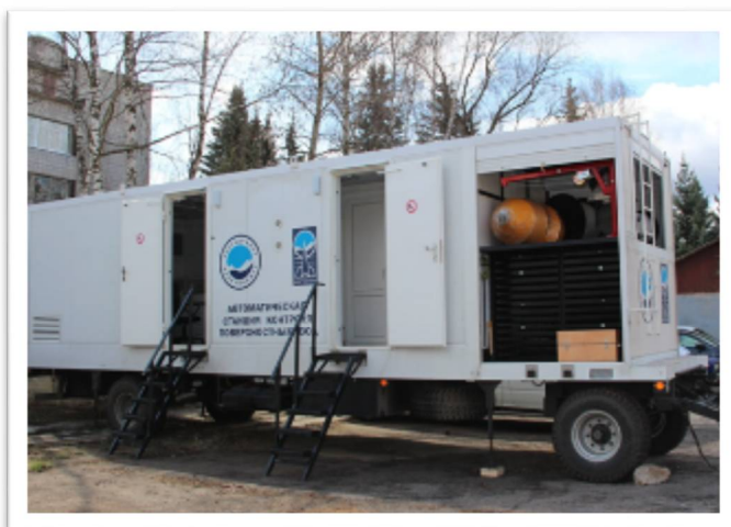
Передвижная автоматическая станция контроля воды (НПО «Тайфун»)
